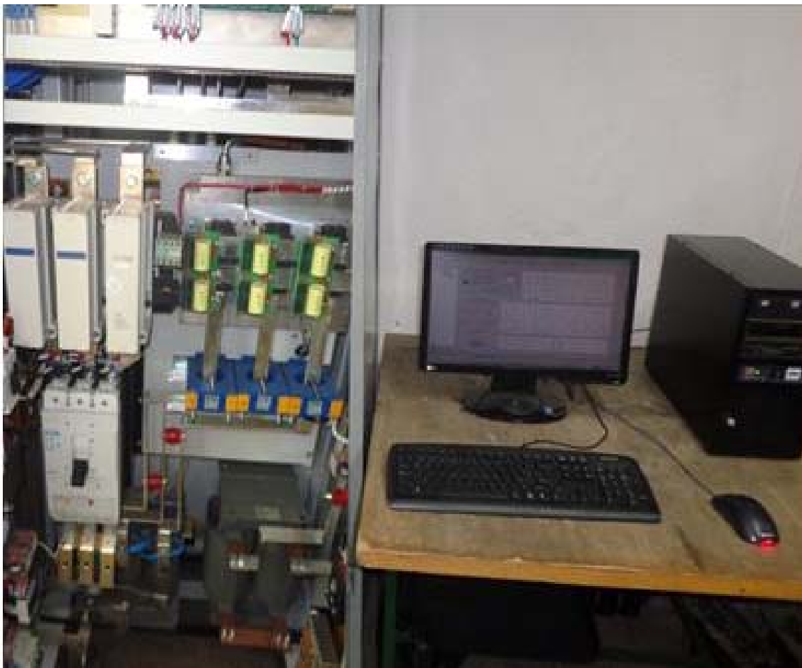
Fig. 2.4. Invertorul și calculatorul cu sistemul DSP dSPACE 1103.
