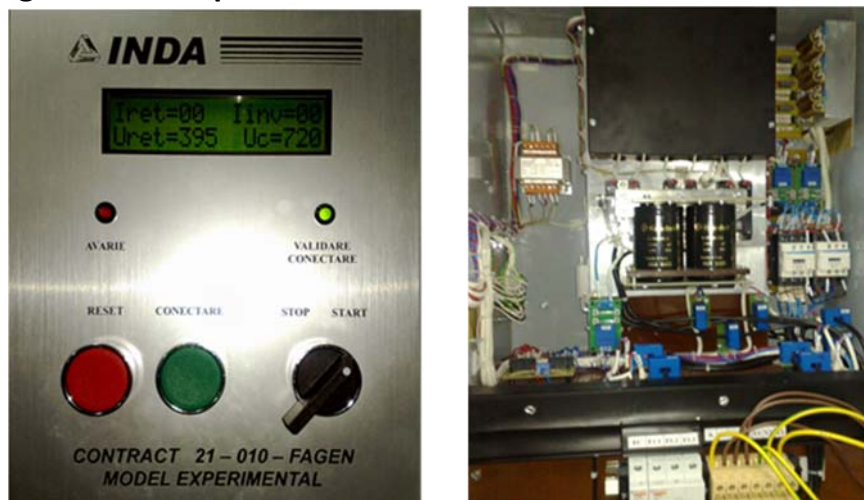
Fig. 1.2. Vedere frontală și interioară a filtrului activ paralel.
