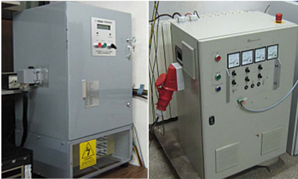
Fig. 1.3. Standul experimental cu evidențierea filtrului activ paralel și sarcinii deformante
